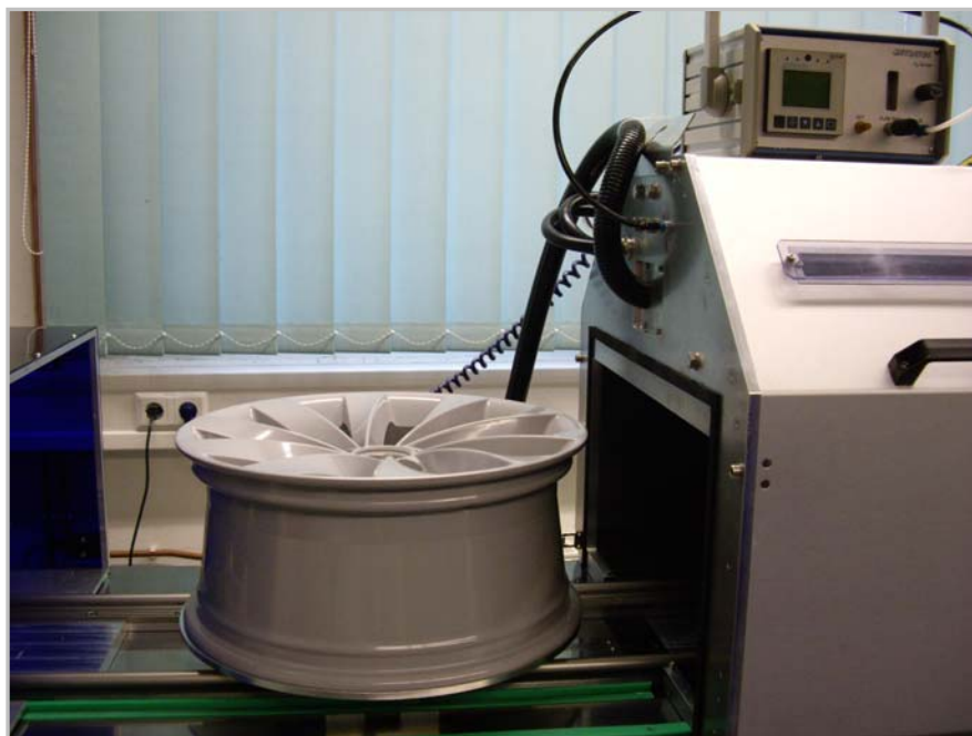
Bild 6: Die Felge befindet sich in Startposition, wird dann nach rechts in den Inert-Raum gefahren und unter dem MBS-3D positioniert. Nach einer 180°-Drehung wird die Felge wieder herausgefahren und kann entnommen werden.
