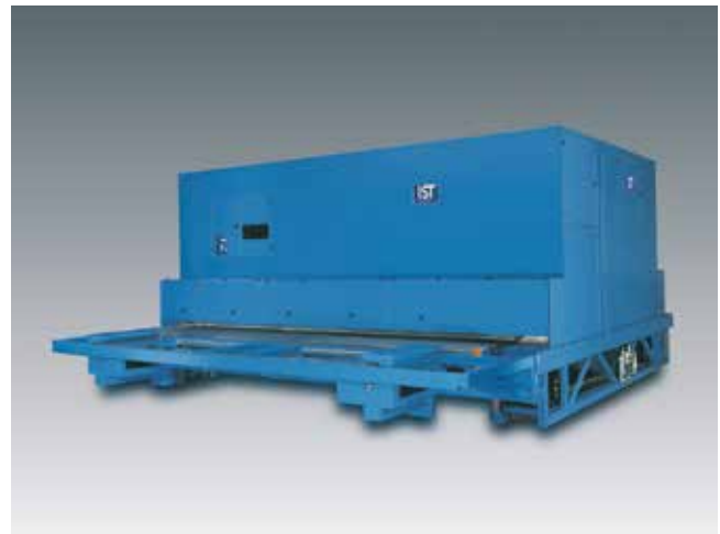
UV-Anlage zur Fußbodenlackierung
